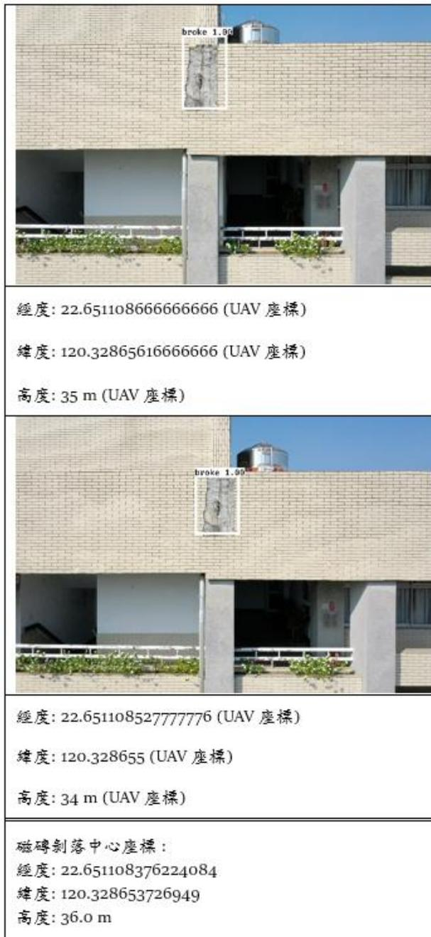
圖 6 (1) 實驗基地外牆磁磚剝落位置與座標
