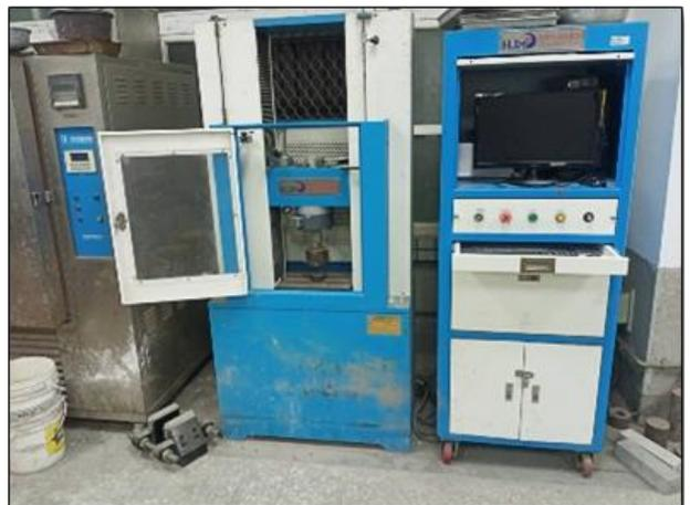
圖 7 水泥砂漿抗壓試驗儀
