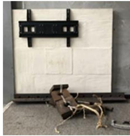
圖 28 第九塊質量塊(夾具滑脫)
