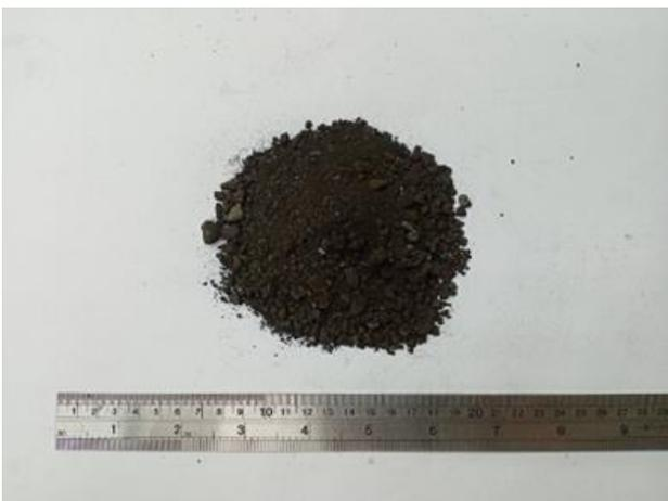
圖 1 再生瀝青混凝土砂
