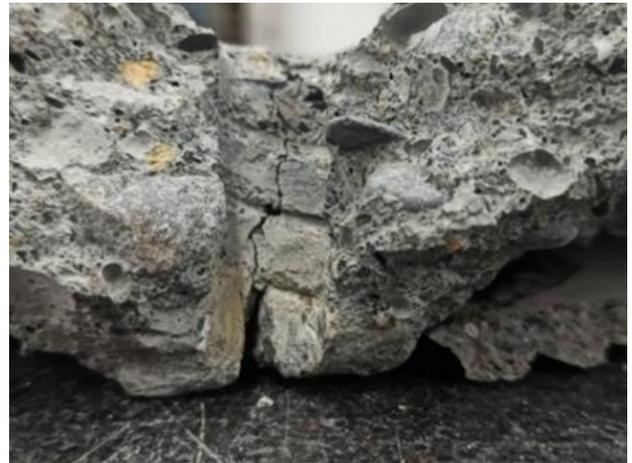
(圖 17) 混凝土螺牙軌跡
