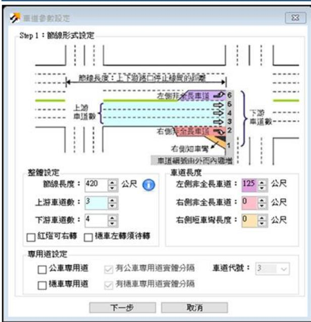
圖 9 節線 3(南出匝道漸變岔出左轉專用車道) 示意圖
