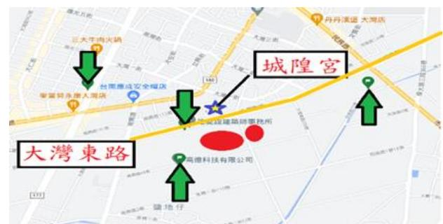
圖 2 研究場址調查點位及液化噴砂示意圖
