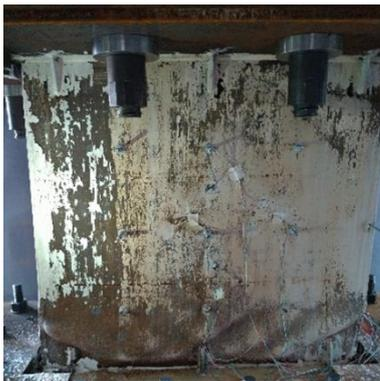
圖 11 LNA-20 底部大面積挫屈
