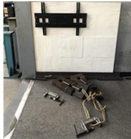
圖 23 第十塊質量塊(夾具滑脫)
