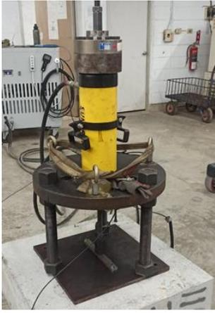
(圖 19) 侷限抗拉設備示意圖
