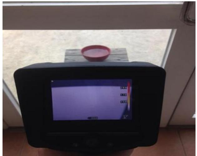
圖 2 熱顯像儀無法穿透玻璃偵測溫度 (2017.6.26.拍攝)
