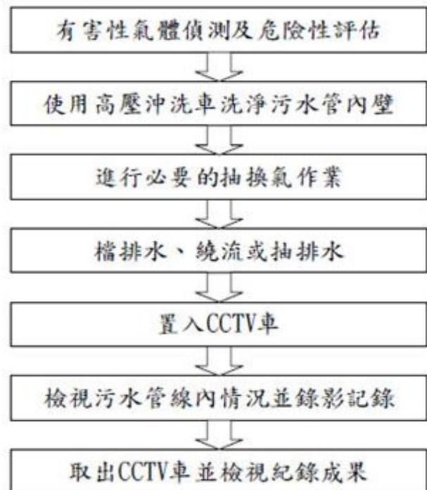
圖 4 CCTV 管渠調查流程圖
