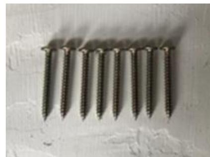
圖 25 試驗後之螺絲(無損壞)
