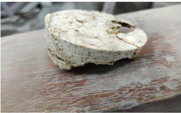
照片 4.9 咕咾石單軸抗壓試驗 4(抗壓後試體)
