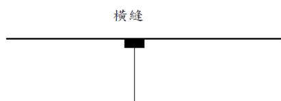
圖 2-2 接縫式混凝土鋪面(綴縫筋)【4】
