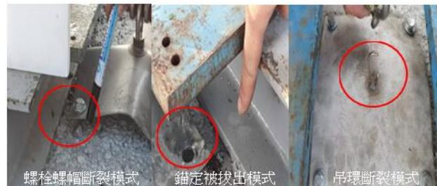
圖 11 拉拔試驗外觀之破壞模式
