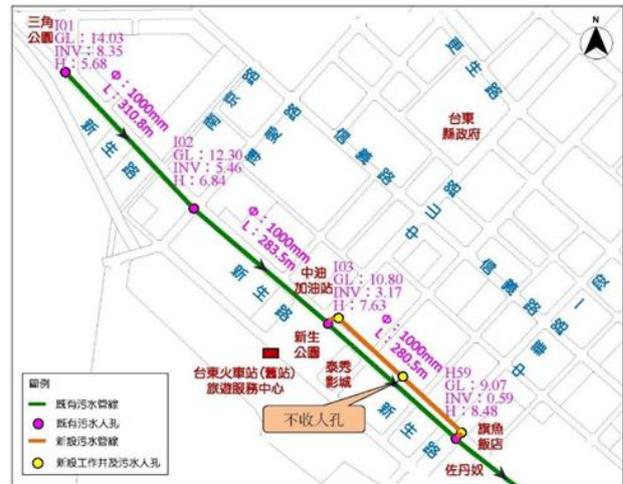
圖 16 I03→H59 管線新設示意圖
