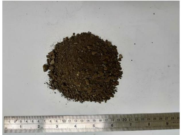
圖 2.再生瀝青混凝土
