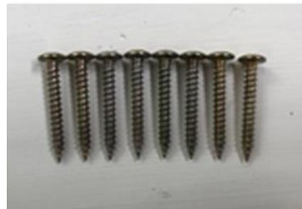
圖 30 試驗後之螺絲(無損壞)
