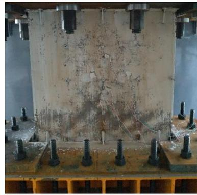
圖 13 LNA-EQ 底部大面積挫屈
