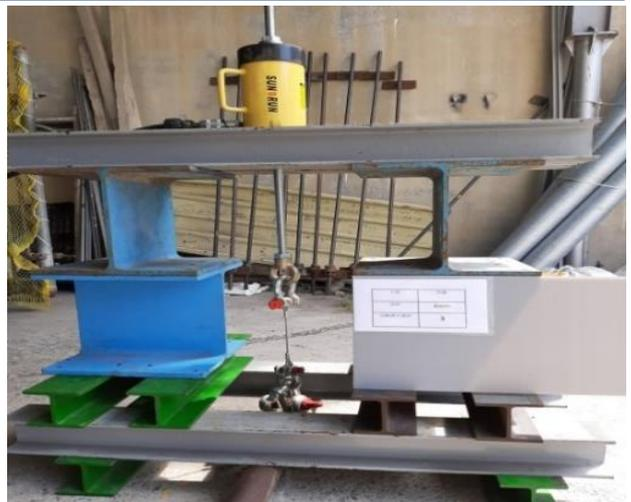
圖 5 拉拔強度測試
