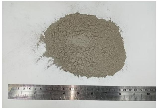
圖 3.再生瀝青混凝土
