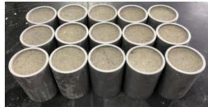
圖 18 完成拆模之試體
