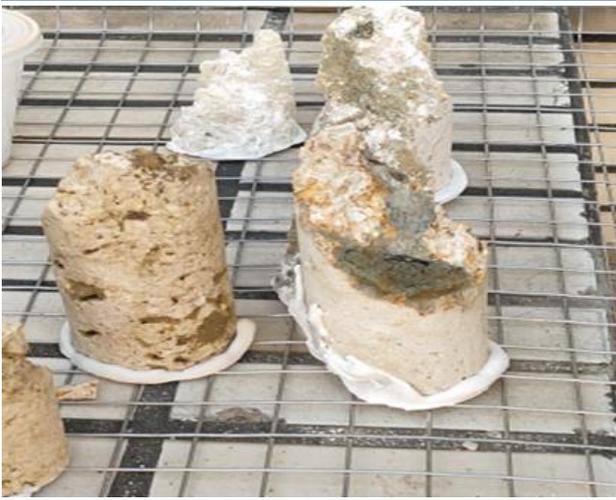
照片 4.9c 咕咾石單軸抗壓試驗 3(壓後試體)
