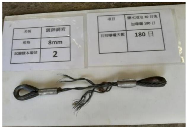
圖 7 拉力破壞後試驗樣本
