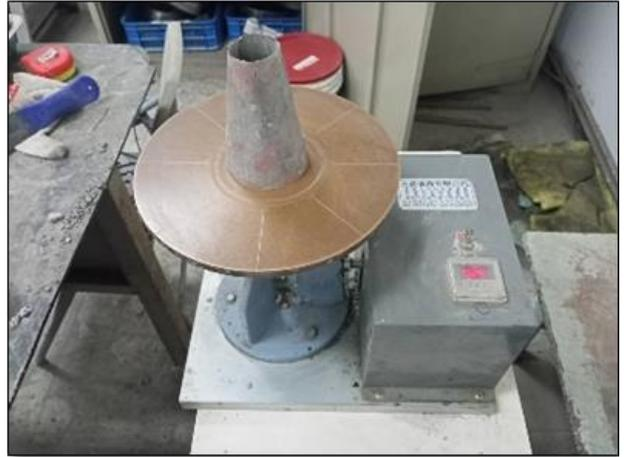
圖 6 流度試驗儀
