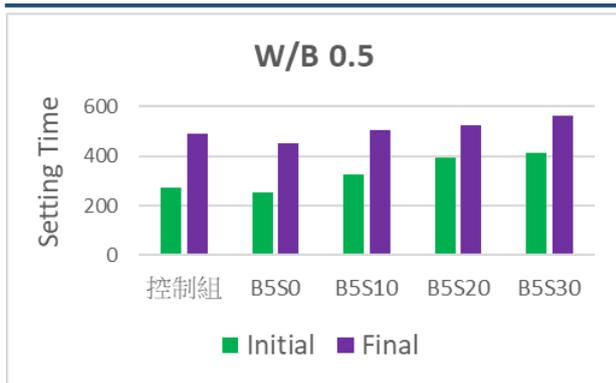
圖 4 含蔗渣灰水泥砂漿之凝結時間(水膠比 0.5)
