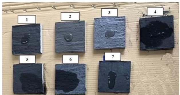
圖 15 含底漆之防水測試
