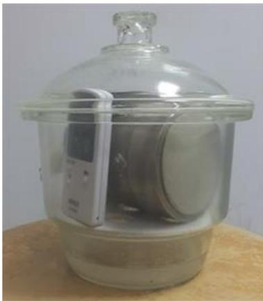
圖 5 水汽平衡法試驗裝置
