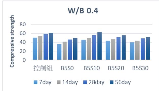
圖 6 含蔗渣灰水泥砂漿之抗壓強度(水膠比 0.4)
