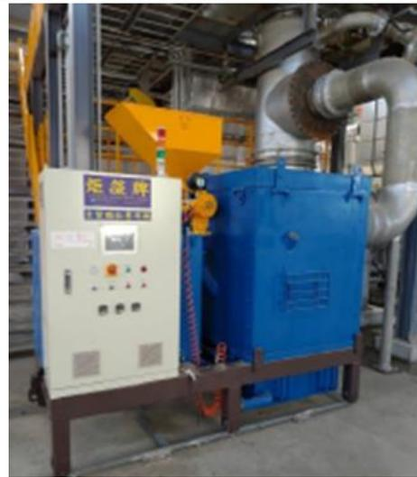
圖 5 宜蘭廠再利用設備-炭化爐
