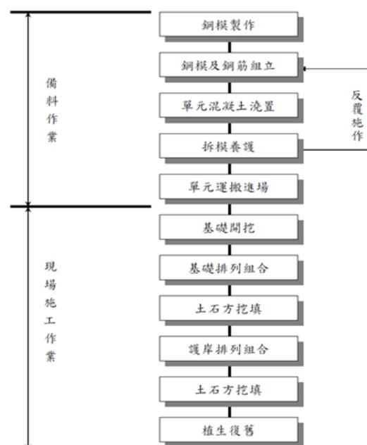
圖 2. 野溪整治構件預鑄化工法施工流程圖
