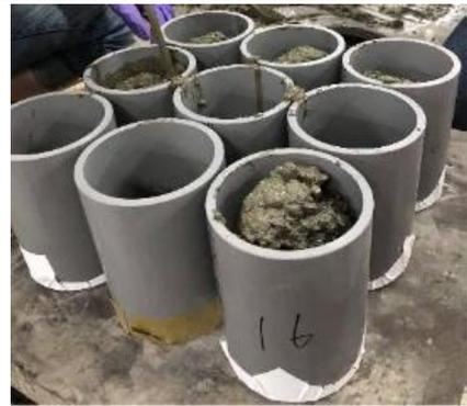
圖 17 混凝土分層灌漿至 PVC 管
