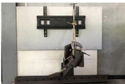
圖 33 第七塊質量塊(夾具滑脫)
