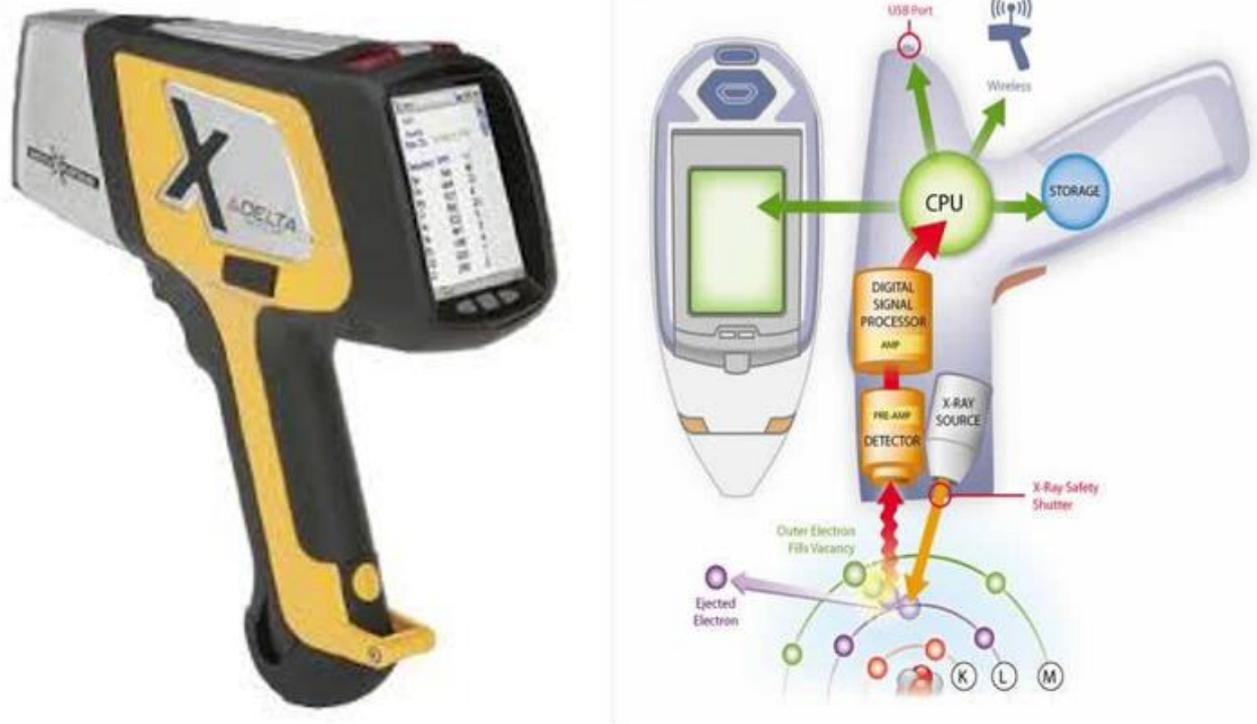
圖 5 手持式 X 射線螢光分析儀(XRF) [3]
