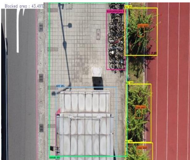
圖 12、件辨識並計算面積成果
