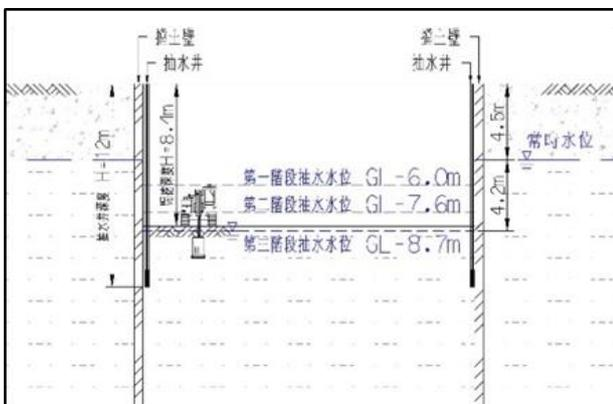
圖 30 抽水井配置剖面示意圖
