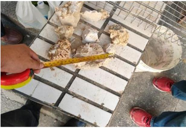
照片 4.6b 破碎後咕佬石粒徑量測
