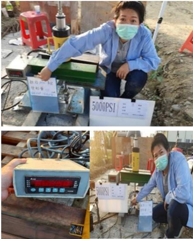
圖 10 拉拔強度試驗
