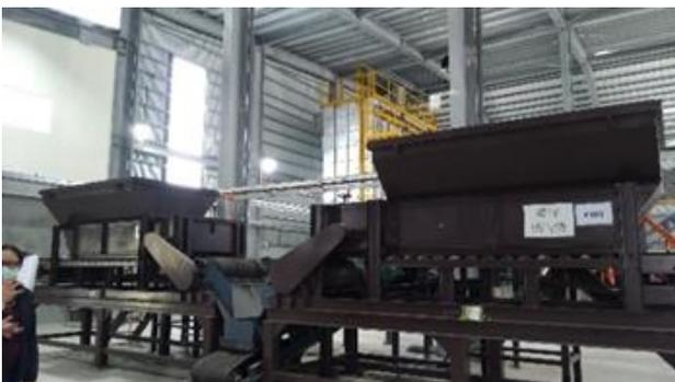
圖 8 臺南仁德廠再利用設備-破碎供料機
