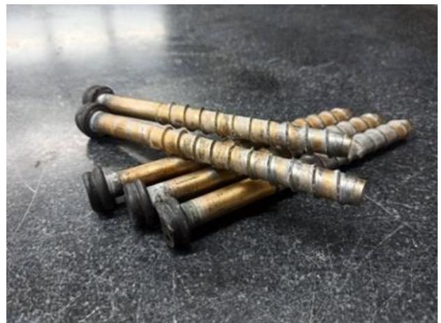
(圖 18) 拉出破壞測試件
